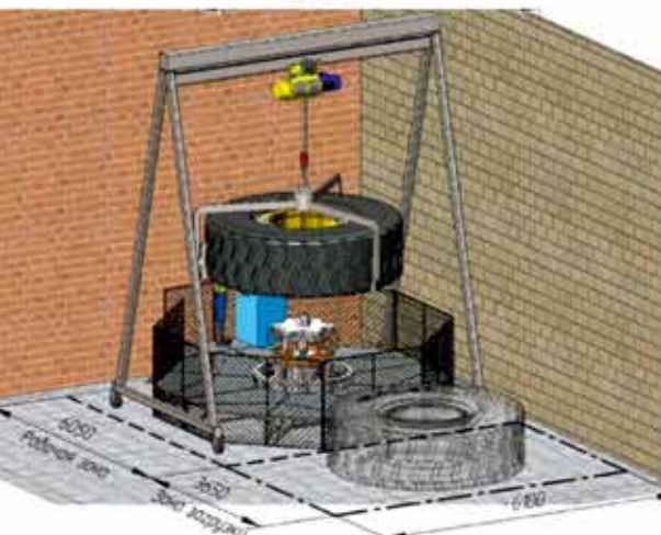
ШИНОМОНТАЖНЫЕ СТЕНДЫ ДЛЯ РАЗБОРКИ И СБОРКИ КРУПНОГАБАРИТНЫХ КОЛЁС С КОЗЛОВЫМ КРАНOM НА ЦЕЛЬНОЛИТЫХ КОЛЁСАХ
